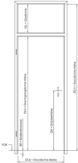
Kämpferprofil eingebaut in Zarge mit Seitenlichte
