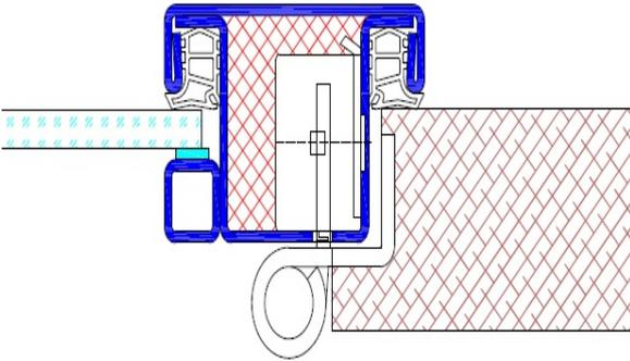
Profil K1 / mit eingebauter Schlossaufnahme
