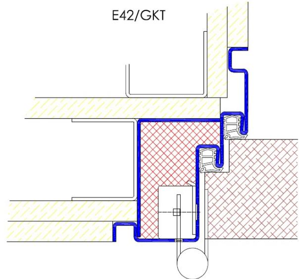
Profil E42 / Einbau in Betonschalung
