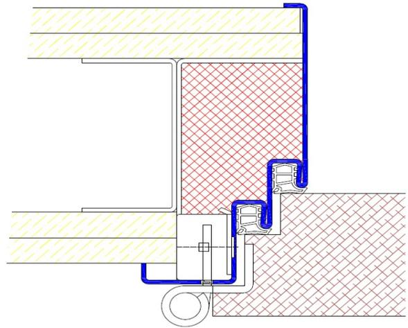
Profil E30 / Einbau in Betonschalung
