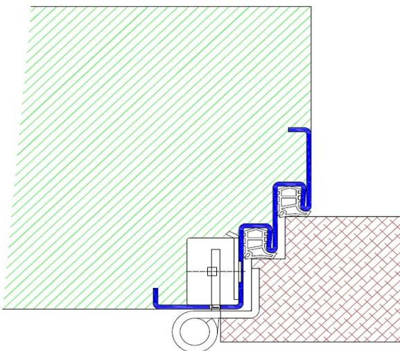
Profil E30 / Einbau mit Schraubmontage
