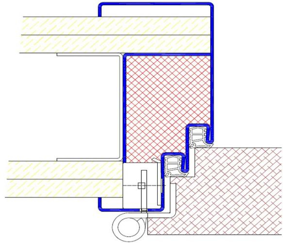
Profil B30 / Einbau in Betonschalung
