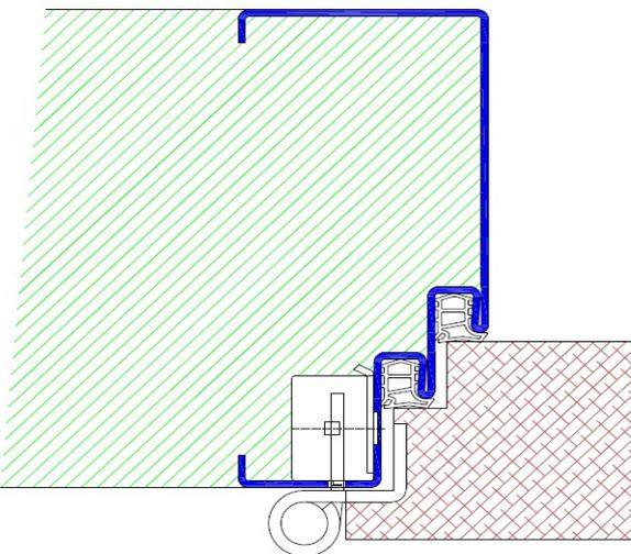
Profil B30 / Einbau mit Schraubmontage
