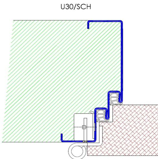
Profil U30 / Einbau mit Schraubmontage
