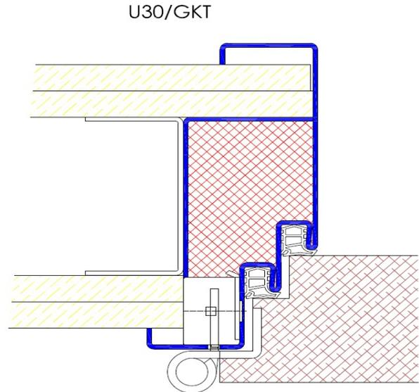
Profil U30 / Einbau in Betonschalung
