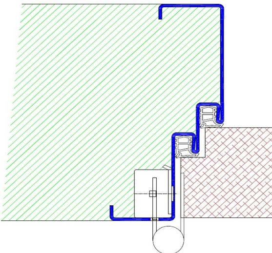
Profil U40 / Einbau mit Schraubmontage
