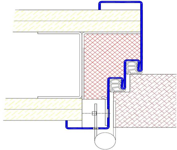
Profil U40 / Einbau in Betonschalung
