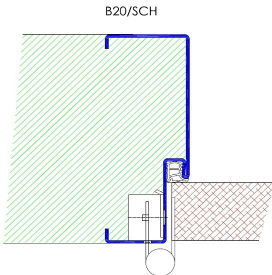
Profil B20 / Einbau mit Schraubmontage
