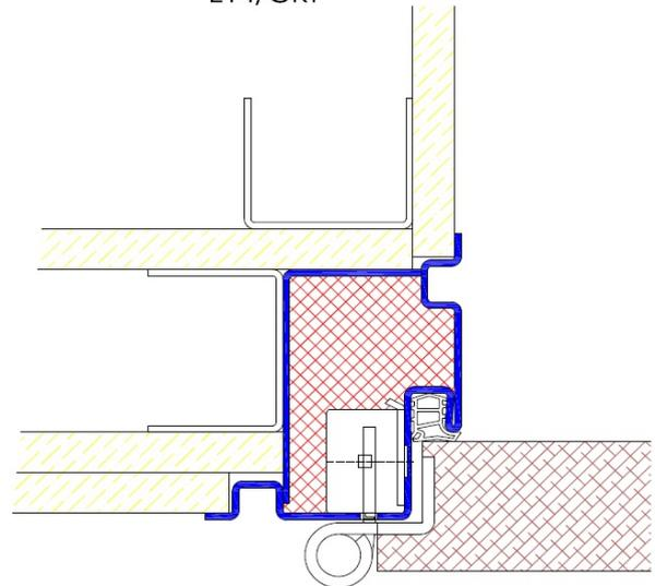
Profil E14 / Einbau in Betonschalung
