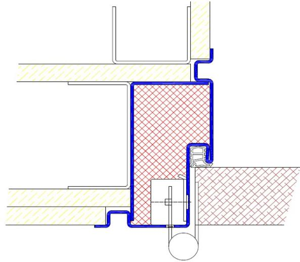
Profil E24 / Einbau in Betonschalung
