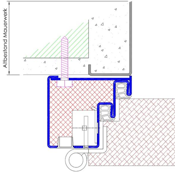
Profil V30 / Einbau in Bestandszarge
