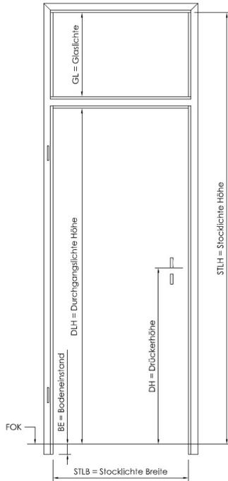
Kämpferprofil eingebaut in Zarge mit Seitenlichte
