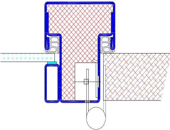
Profil K20 / mit eingebauter Schlossaufnahme
