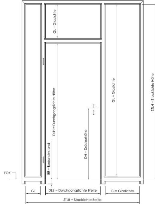
Kämpferprofil eingebaut in Zarge mit Ober- und 2-facher Seitenlichte
