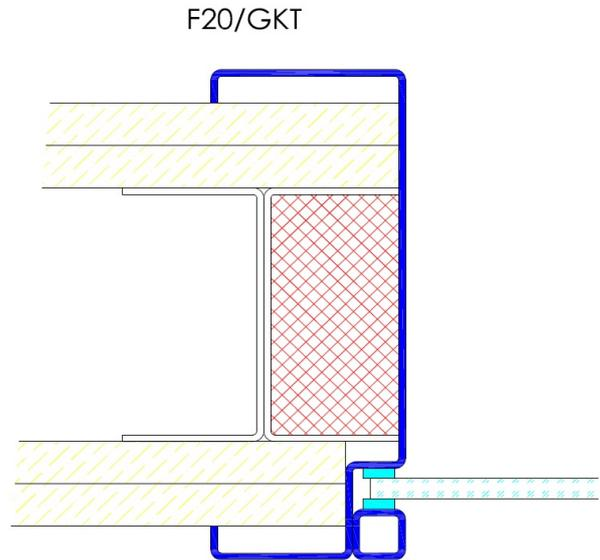
Profil F20 / Einbau mit Schraubmontage
