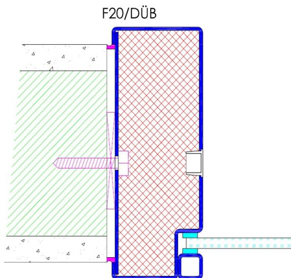
Profil F20 / Einbau in Betonschalung
