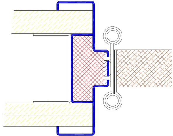
Profil P10 / Einbau mit Schraubmontage
