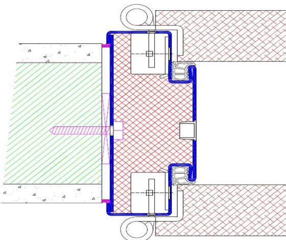
Profil Z10 / Einbau in Betonschalung
