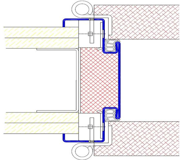
Profil Z10 / Einbau mit Schraubmontage
