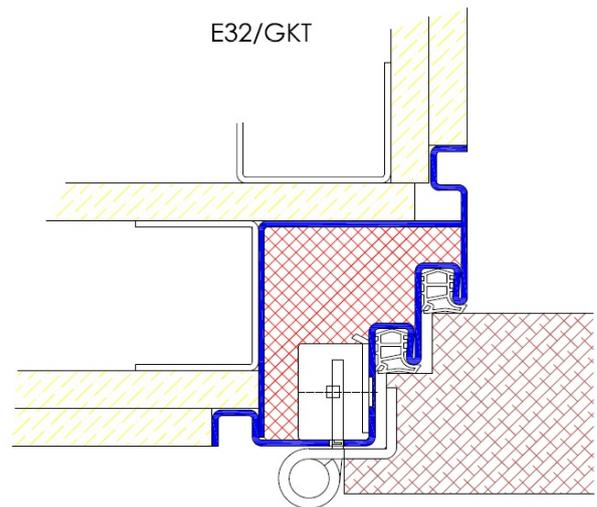
Profil E32 / Einbau in Betonschalung
