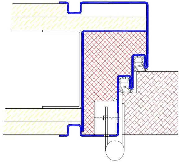
Profil B44 / Einbau in Betonschalung
