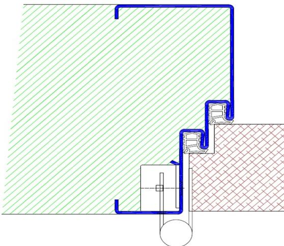
Profil B40 / Einbau mit Schraubmontage
