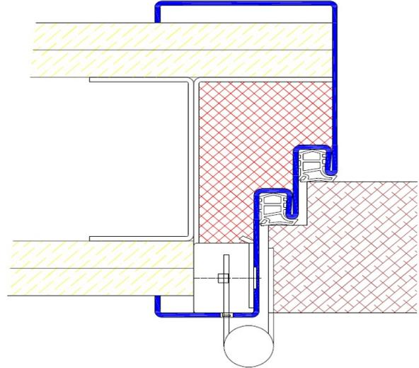
Profil B40 / Einbau in Betonschalung
