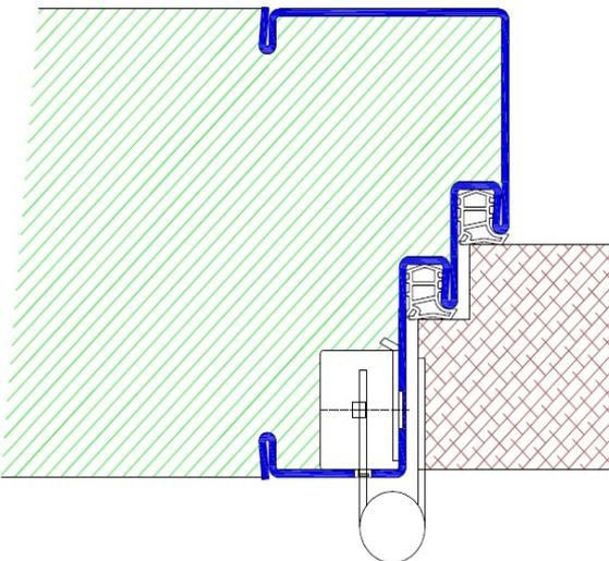
Profil B46 / Einbau mit Schraubmontage
