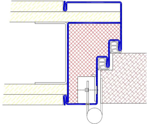
Profil B46 / Einbau in Betonschalung
