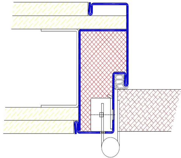
Profil U26 / Einbau in Betonschalung
