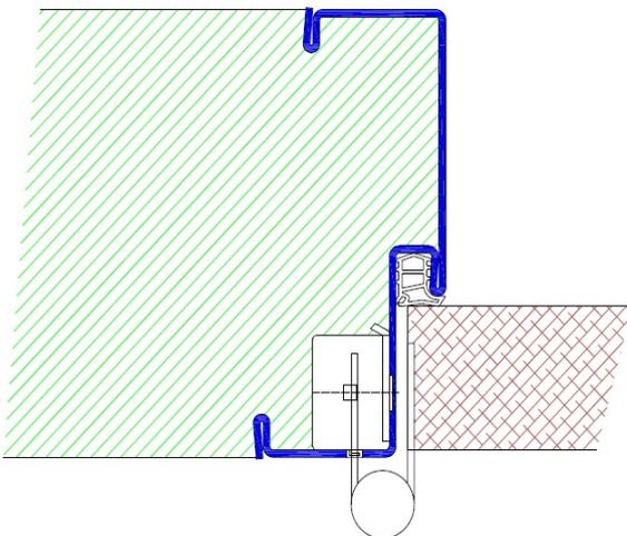
Profil U26 / Einbau mit Schraubmontage
