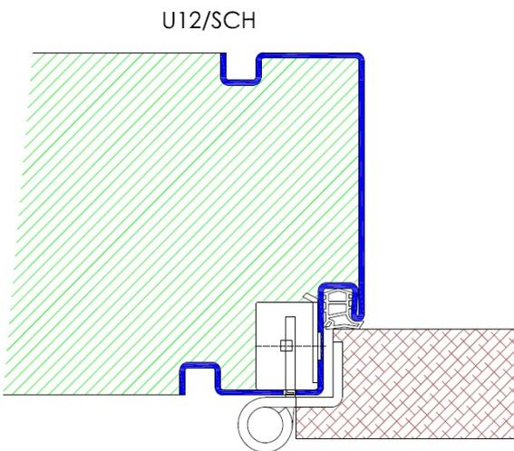
Profil U12 / Einbau mit Schraubmontage
