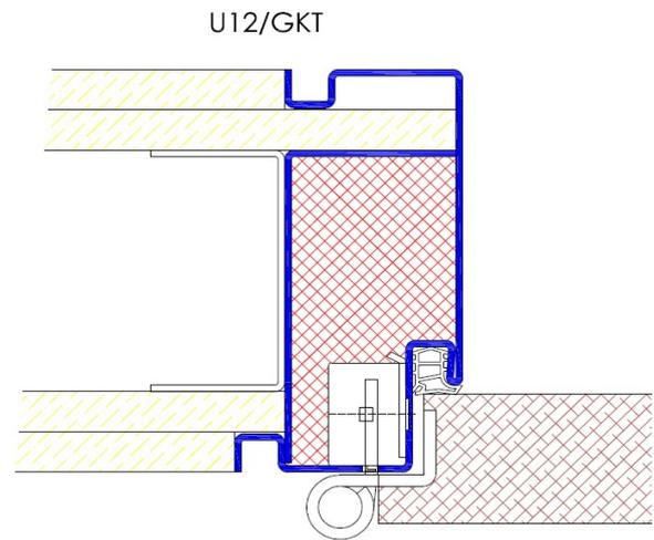
Profil U12 / Einbau in Betonschalung
