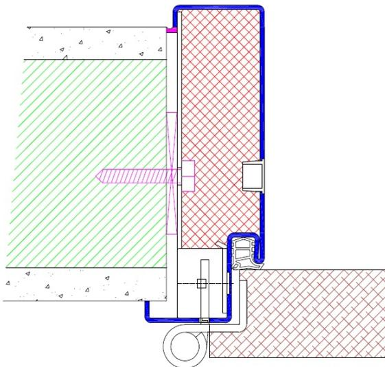
Profil U10 / Einbau in Betonschalung
