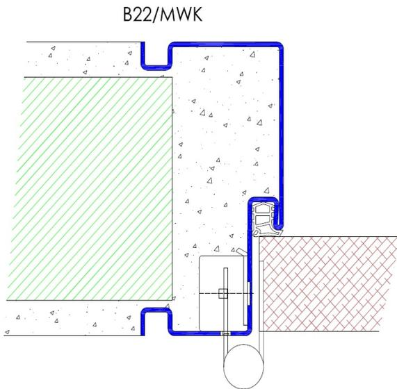
Profil B22 / Einbau in Mauerwerk
