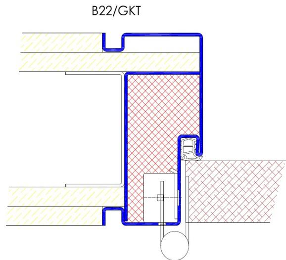
Profil B22 / Einbau in Betonschalung
