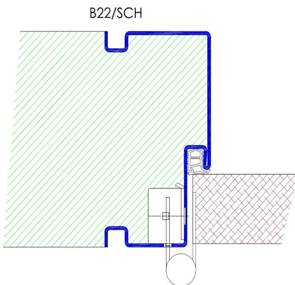
Profil B22 / Einbau mit Schraubmontage
