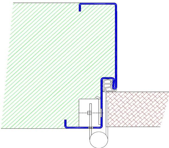
Profil U20 / Einbau mit Schraubmontage
