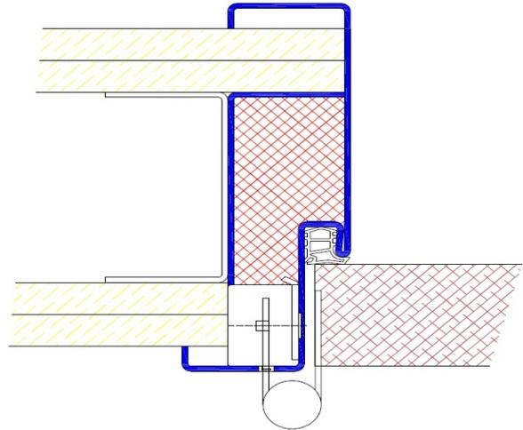
Profil U20 / Einbau in Betonschalung
