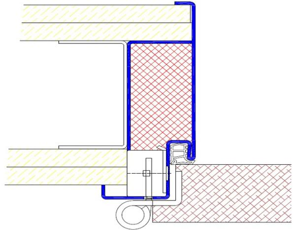
Profil E10 / Einbau mit Schraubmontage
