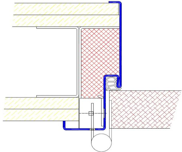
Profil E20 / Einbau mit Schraubmontage
