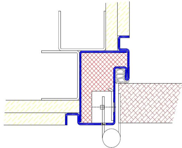
Profil E22 / Einbau in Betonschalung
